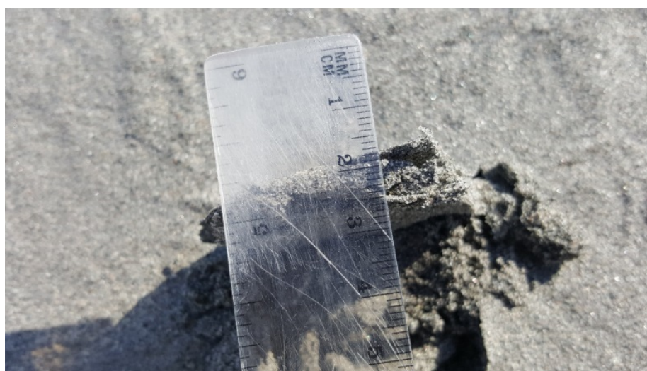
Рис. 1. Образуемый слой анионно-битумной эмульсии
