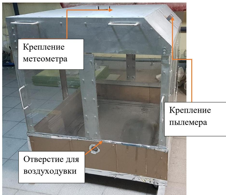
Рисунок 1 – Лабораторная установка «Бункер пылеподавления»
