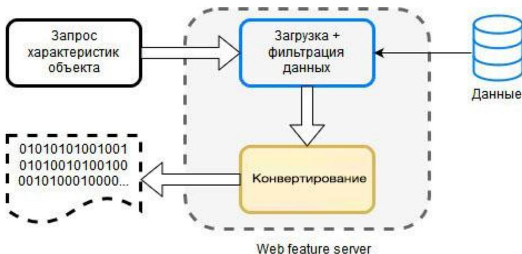
Рисунок 3. Схема работы WFS
