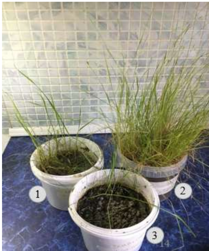
Рисунок 1 – Результаты эксперимента (1 – почва из смеси золошлаков и избыточного активного ила, 2 – почва из золошлаков без примесей, 3 – почва из смеси золошлаков и торфа)
