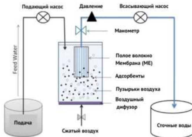
Рисунок 1. Принципиальная схема погружной гибридной системы MF-GAC
