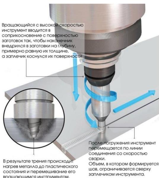
Сварка производится вращающимся инструментом в форме стержня, состоящим из двух основных частей: заплечика или бурта и наконечника. Вращающийся с высокой скоростью инструмент в месте соединения под давлением внедряется в свариваемый материал так, чтобы наконечник внедрился в заготовки на глубину, примерно равную их толщине, а заплечик коснулся их поверхности. После этого
