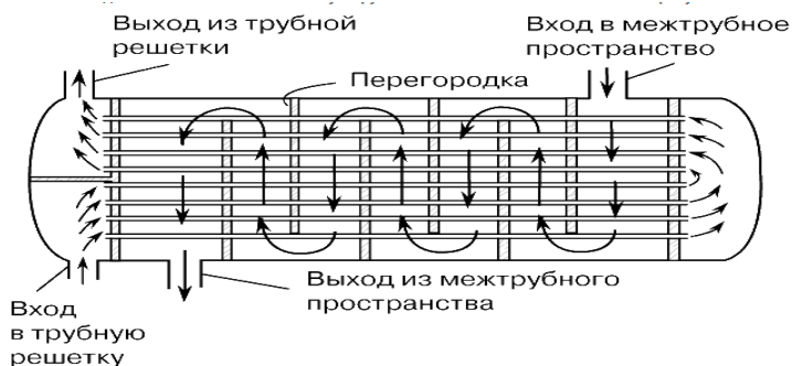
Рис. 1. Схема кожухотрубчатого теплообменника
