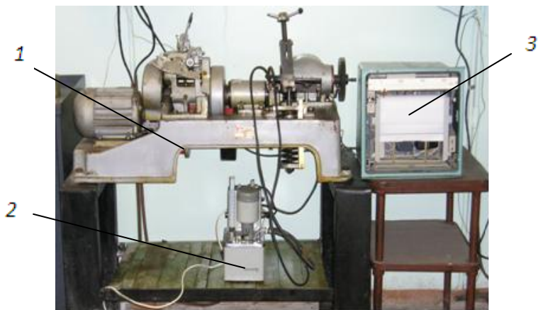
а) общий вид: 1 – машина трения МИ-1М; 2 – термостат; 3 – потенциометр КСП-4.
