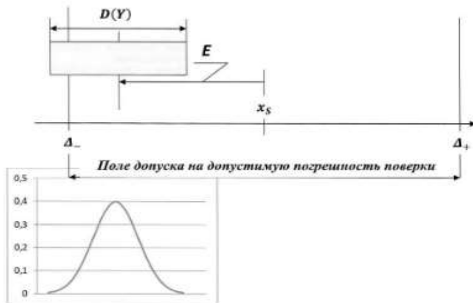
Рисунок 1 – Схема образования суммарной погрешности при оценке пригодности средства измерения
